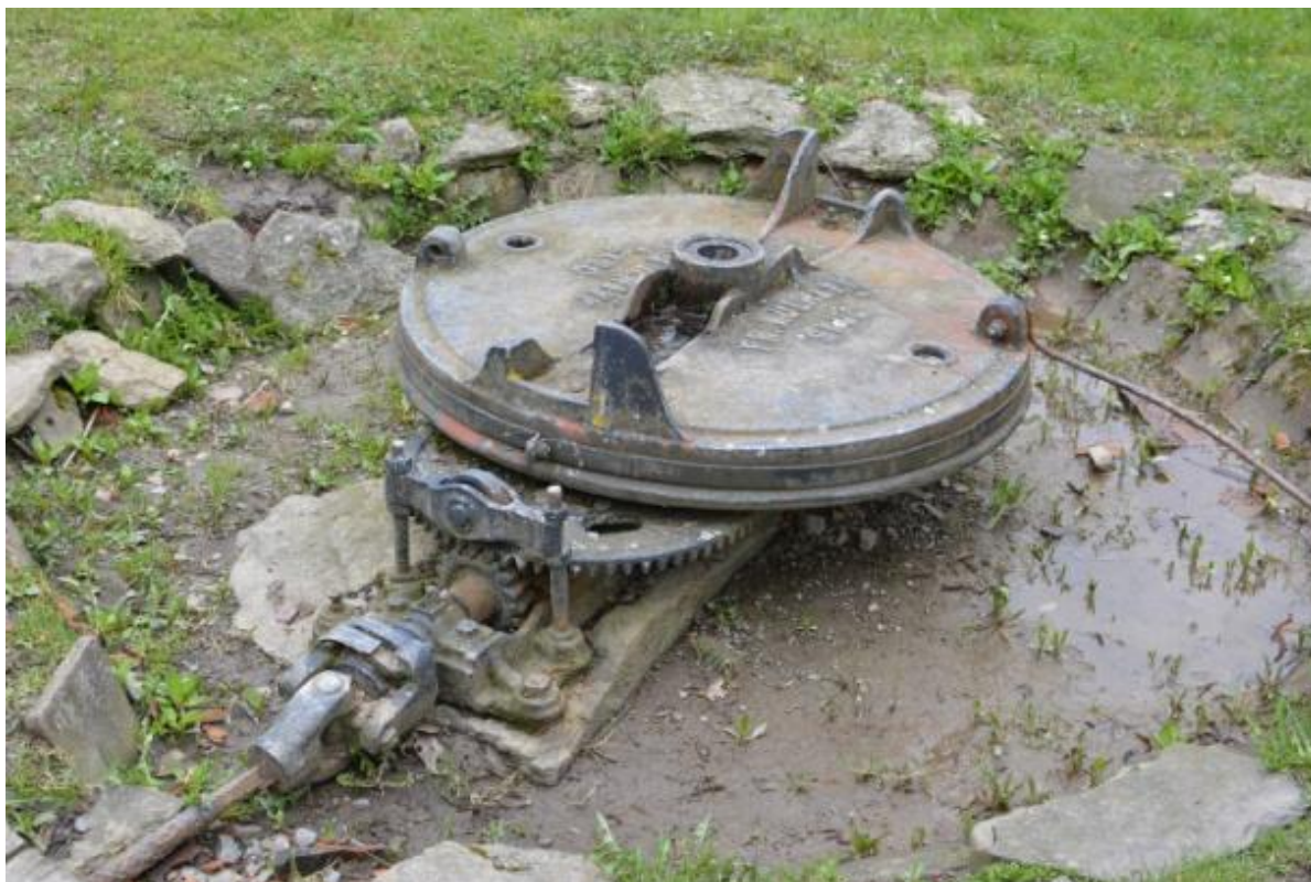
Obr. 4: Bezpečnostní ležatý žentour v Muzeu v přírodě Vysočina, Veselý Kopec (okres Chrudim). Foto Radim Urbánek, 2020.
